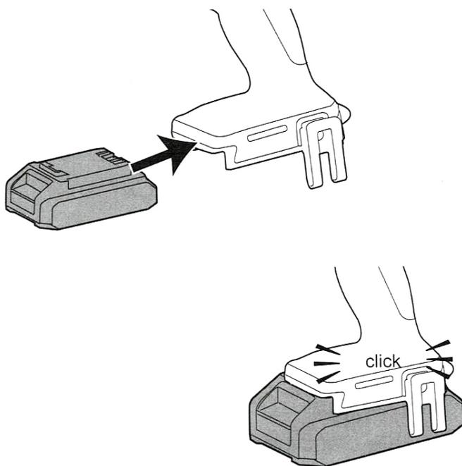
Для извлечения АКБ нажмите и удерживайте кнопку фиксации АКБ, после чего извлеките батарею из устройства.
